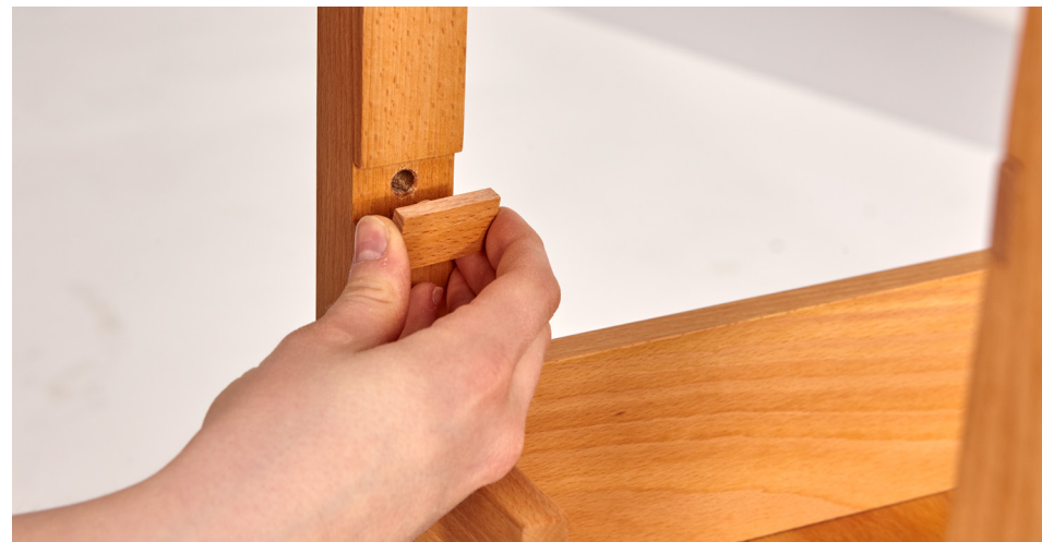
9. Für eine schönere Optik Abdeckplättchen auf frei bleibende Ausnehmungen setzen.
