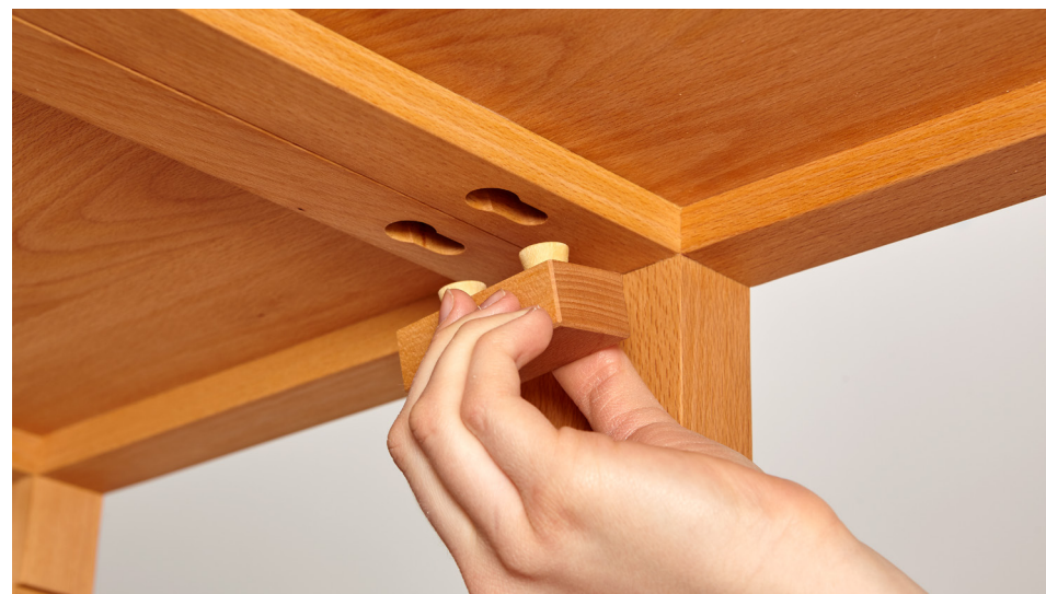
10. Zur festen Kopplung des Regals an den Schreibtisch Quint die beiden Verbindungsteile wie abgebildet montieren: Gratdübel an der weiten Stelle der Ausfräsung einsetzen und dann zur engen Stelle hin festziehen.
