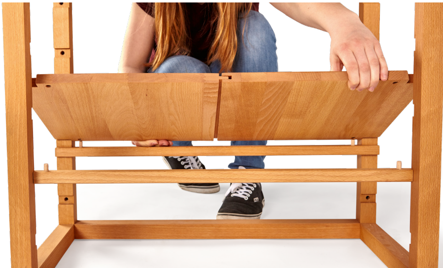
4. Fachbrett auf die Auflageleisten legen (Dübel in die Bohrungen an der Fachbrettunterseite).
